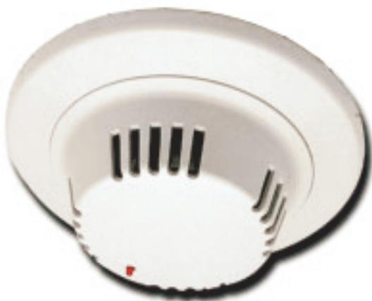
A série D285 é uma série de detectores de fumaça fotoelétricos de baixo perfil que incorporam o conceito de base e detector separados, permitindo a utilização com bases de 2 e de 4 fios. O desenho patenteado da câmara oferece uma imunidade superior aos falsos alarmes causados pela poluição ambiental. O processo de autodiagnóstico da câmara permite verificar a sensibilidade do sensor através da simples observação da frequência em que pisca o LED externo.
