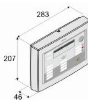
Terminal do repetidor FT2010-C1
